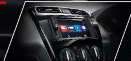
ระบบเครื่องเสียง 2 DIN หน้าจอสัมผัสขนาด 6.2 นิ้ว พร้อมเครื่องเล่น DVD / MP3
